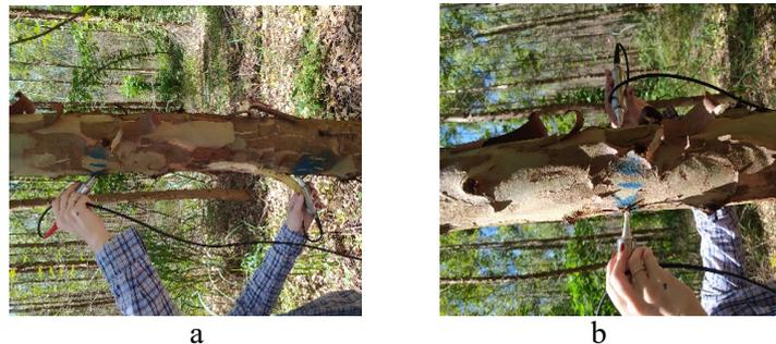
Figura 1. (a) Ensaio de ultrassom com medições indiretas (transdutores posicionados na mesma face) e (b) ensaio de ultrassom com medição direta (transdutores em faces opostas) na direção radial.
